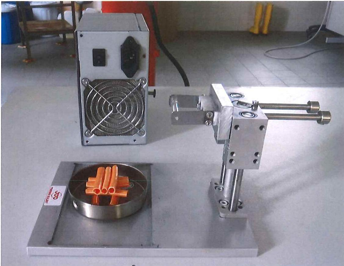
Abb. 11: Versuchsaufbau Seitenansicht mit aufgeschichteter Kabelisolierung als Brennmaterial, Ampullenhalterung mit E-Bulb in Ausgangslage außerhalb des Brenntellers; hier: nahezu identischer Versuchsaufbau aus dem Jahr 2013
