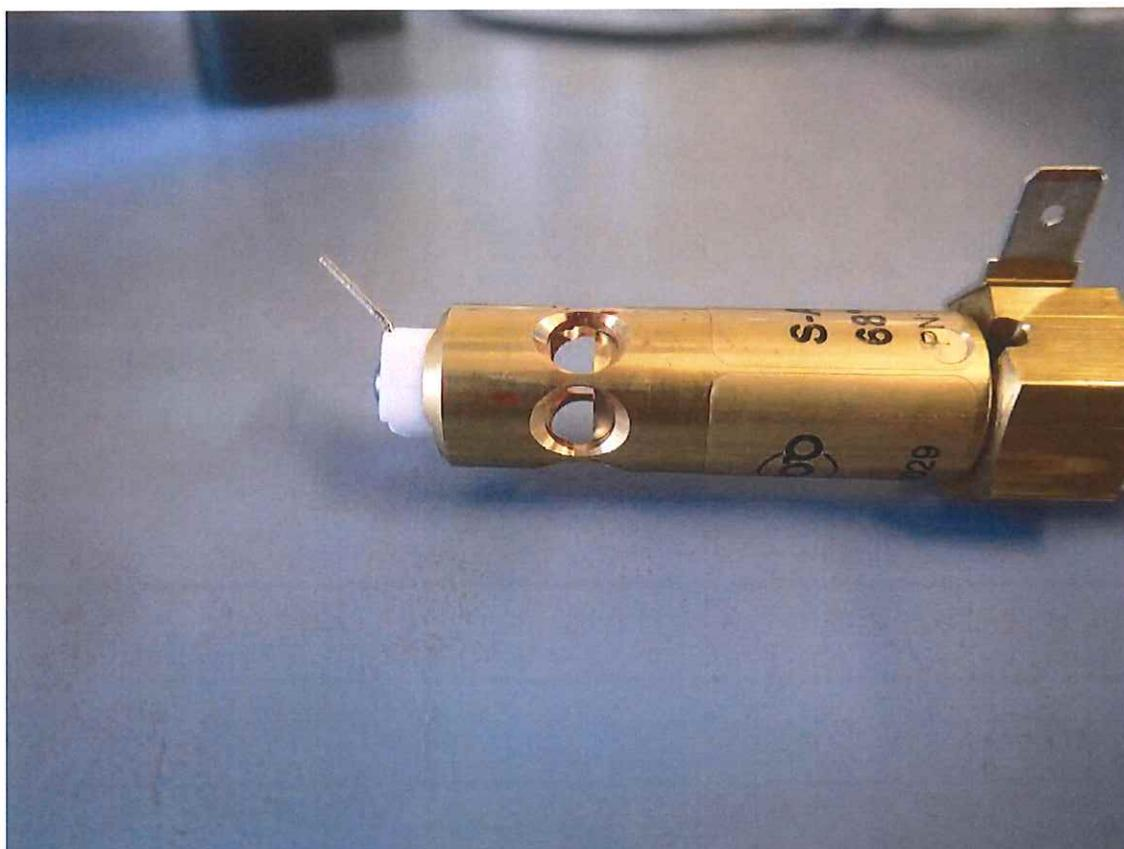
Abb. 25: S-R-AMFE Steuer- und Auslöseeinheit nach Auslösung, Thermo Bulb ist zerborsten
