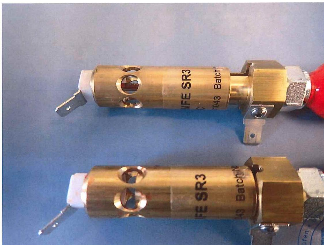
Abb. 26: S-R-AMFE Steuer- und Auslöseeinheit vor und nach Auslösung
