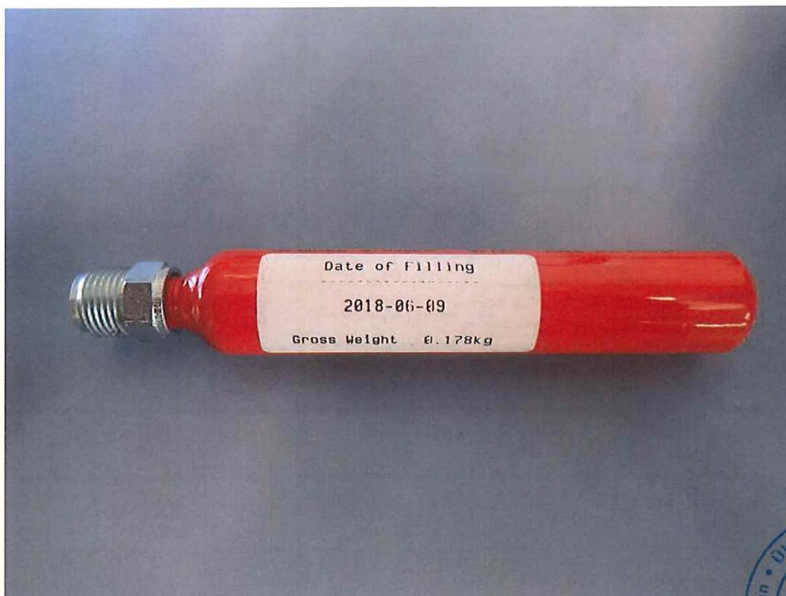
Abb. 3: Aufschaubare Gaskartusche als Löschmittelbehälter mit 3M™ NOVEC™
