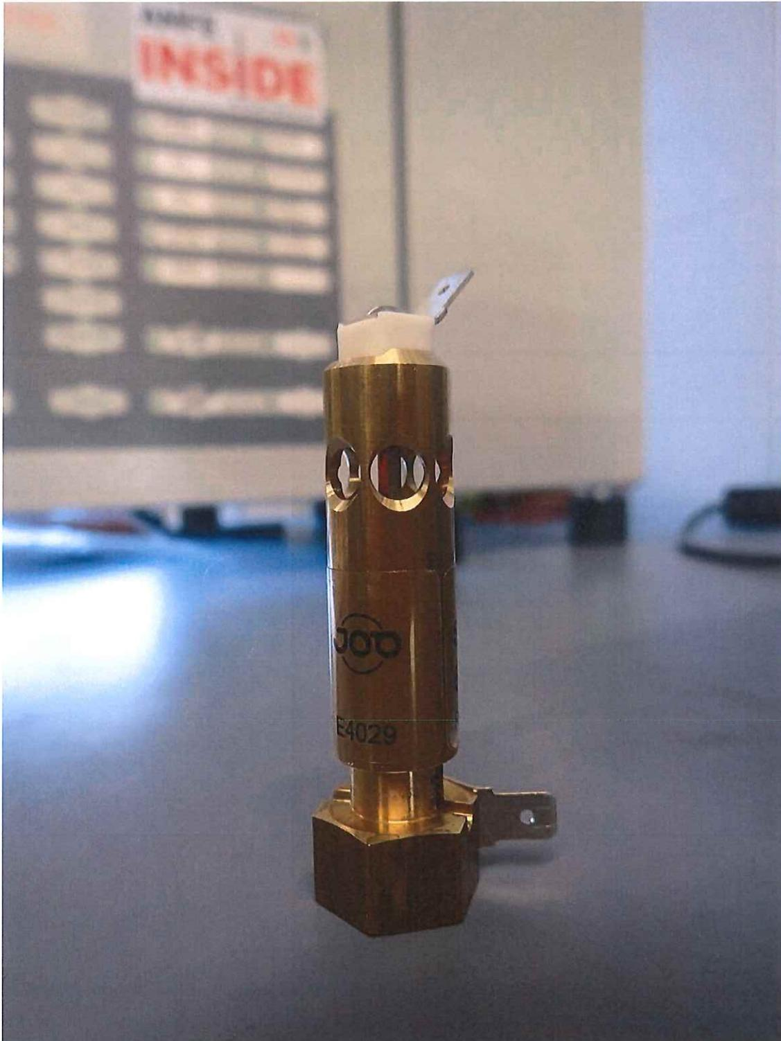
Abb. 15: Steuer- und Auslöseeinheit der Mini-Löschanlage S-AMFE mit S-Type Thermo Bulb (lineare Leiterbahnen) und ohne Löschmittelpatrone
